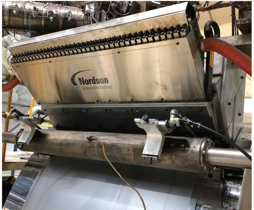
*EINE 25%IGE STEIGERUNG DER PRODUKTIONSMENGE VON BOPP-FOLIEN MITHILFE DER EDI®-DÜSE verzeichnen die in Indien ansässigen Asia Poly Films Industries. Die automatische Autoflex™-Düse verringert außerdem Dickenschwankungen.*
