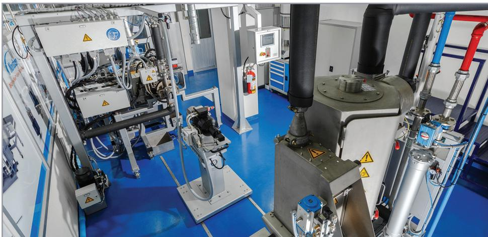
*DAS VOLLAUSGESTATTETE BKG®-VERSUCHSZENTRUM IN THAILAND hat eine komplette Unterwasser-Granulierlinie mit Doppelschnecken-Extruder, zwei Granulatoren, einem Siebwechsler, einer Zahnradpumpe und einem Düsenreiniger, der durch schnelles Säubern einzelner Teile, z. B. Siebplatten, Zeit zwischen den Probeläufen einspart.*
